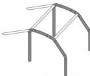
2 oldalsó bukócső / lateral rollbars 2 keresztmerevítő / transverse members
