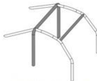
1 főbukócső 2 oldalsó félbukócső 1 keresztirányú merevítő 2 hátsó megtámasztás
