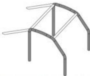
2 oldalsó bukócső 2 keresztmerevítő 2 hátsó megtámasztás
